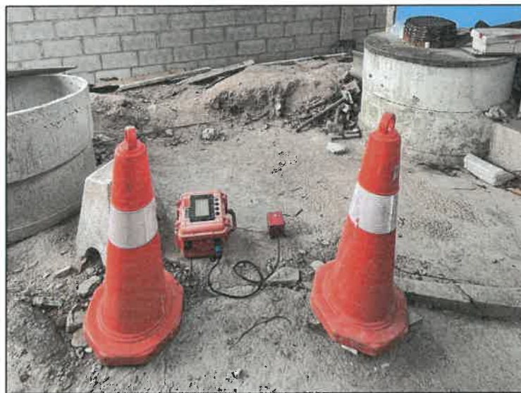
รูปที่ 4.3.3-1 แสดงการตรวจวัดความสั่นสะเทือน ภายในพื้นที่โครงการ
